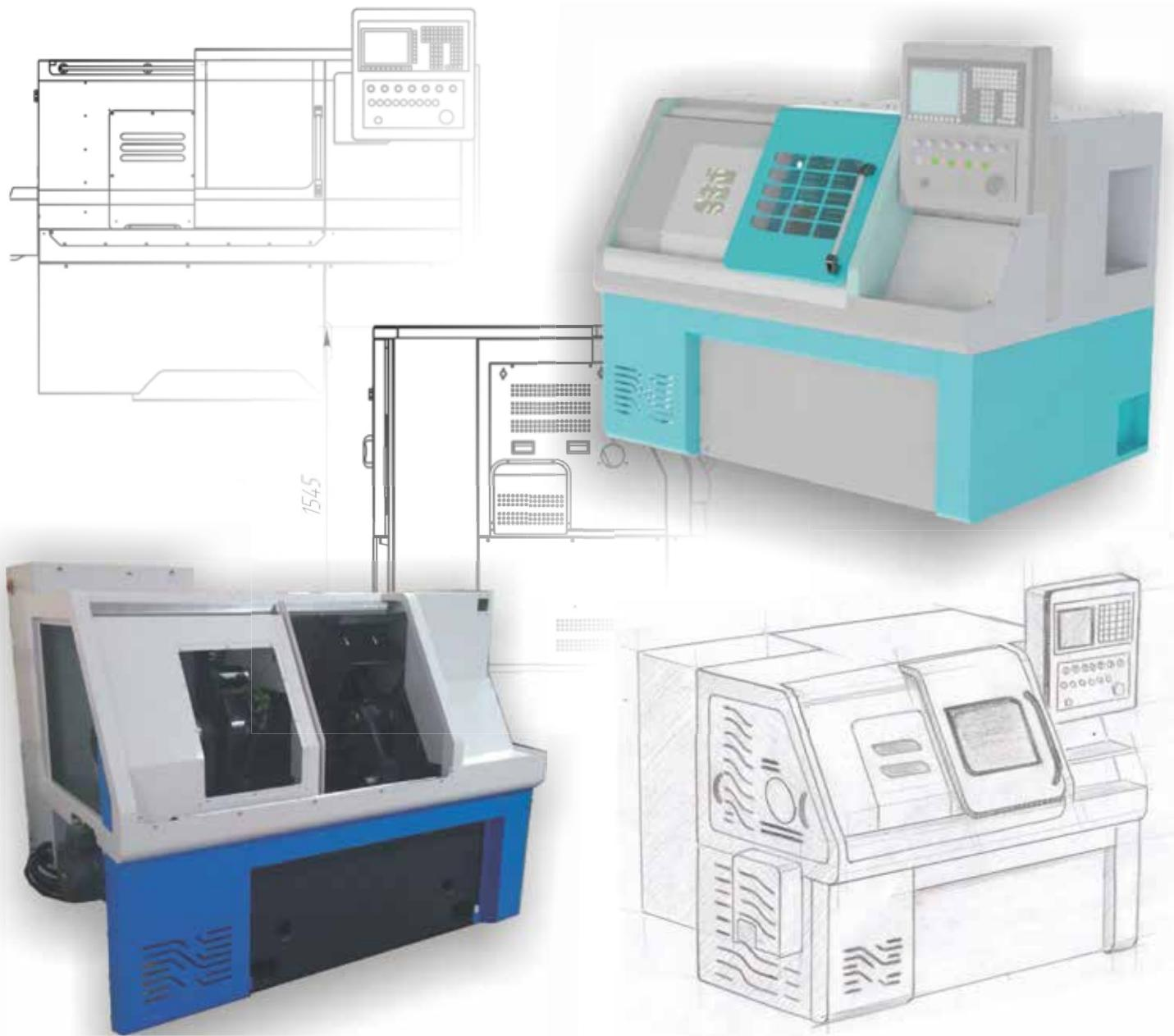
Кабинетная защита представляет собой ограждение вокруг обрабатывающей машины, станка. Наличие кабинетной защиты необходимо для обеспечения безопасности обслуживающего персонала. Помимо этой утилитарной функции защита выполняет и эстетическую роль: внешне красивый станок привлекателен для потребителя, он является источником положительных эмоций для человека работающего на нем.
