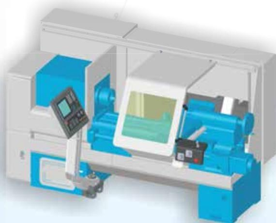
Частичная кабинетная защита для токарно-винторезного станка с оперативной системой управления. Состоит из заднего ограждения для защиты от разбрзгивания СОЖ и выброса стружки, поддона для сбора стружки, подвижного остеклённого защитного экрана и кожуха ремённой передачи. В едином стиле с ограждением выполнен пульт управления системы ЧПУ на поворотной стойке.
