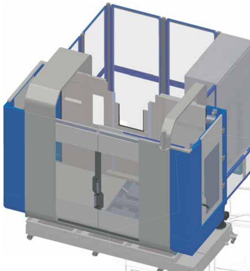
Частичная кабинетная защита вертикального фрезерного станка с ЧПУ. Состоит из ограждения зоны резания со сдвижными и распашными дверьми, а также заднего сетчатого ограждения. Оснащена телескопической защитой направляющих и ШВП, баком сбора стружки и СОЖ.
