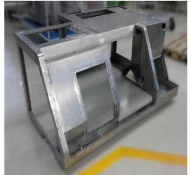
Ограждения зон резания кабинетного типа преследуют две основные цели: защитить рабочего от травм отлетающей стружкой, пылевыми частицами и предупредить возможность травмирования режущим инструментом (например, фрезой) и осколками, отлетающими из-за разрушения инструмента. **(изготовлено 4 версии кабинетного ограждения)**
