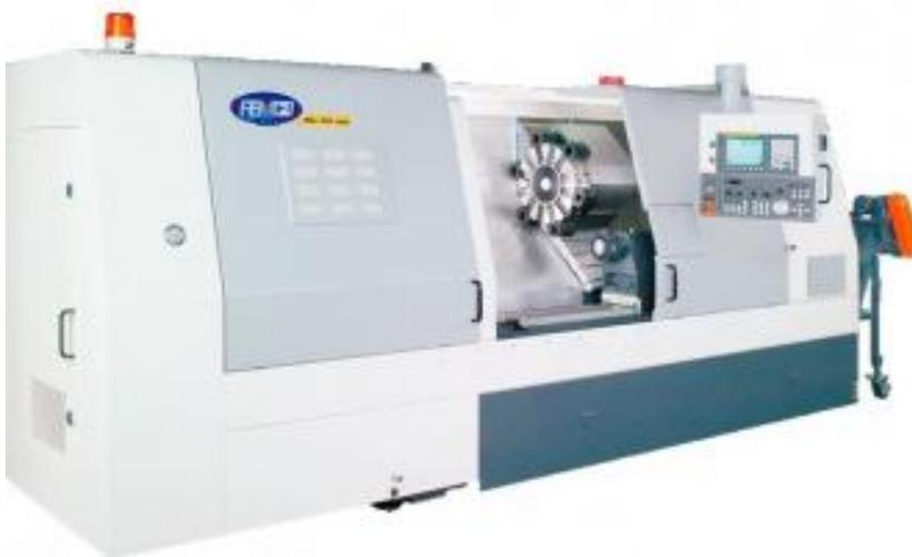
Станок токарный с ЧПУ модели HL-45/1000 предназначен для высокопроизводительной токарной обработки деталей типа «вал», «винт», «фланец», «втулка», «ниппель», «штуцер» и т.д. из различных конструктивных материалов в условиях единичного и мелкосерийного производства. Станок является проверенным временем решением для высокопроизводительной и высокоточной обработки.
